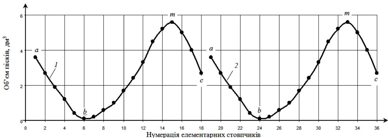
Рис. Б.6.1. Розподіл об'єму твердого в елементарних стовпчиках довжиною \Delta l , розташованих вздовж пісків:
